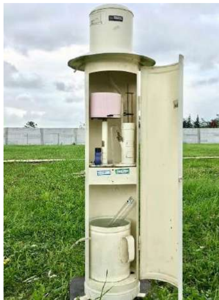
Gambar 3.2 Alat Penakar Hujan Otomatis
