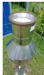
Kondisi corong (baik)
