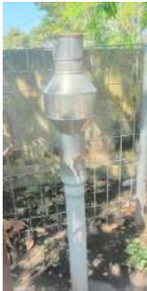
Kondisi alat (tegak) Kondisi corong (baik) Kondisi tiang penyangga (baik)
