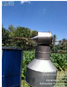
Kondisi corong (baik)
