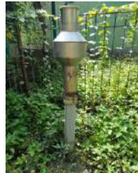
Kondisi ombrometer (tegak)
