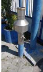
Kondisi tiang penyangga (baik) Kondisi alat (tegak)
