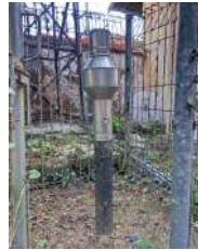
Kondisi alat (tegak) Kondisi tiang penyangga (baik) Kondisi gembok (baik)
