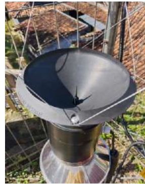
Kondisi corong (baik)
