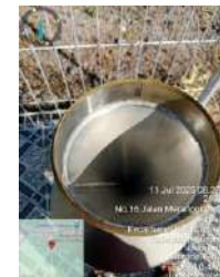
Kondisi corong (baik)
