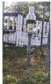
Kondisi ombrometer (tegak)
